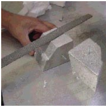
Figura 34 – Proteção sendo limada
