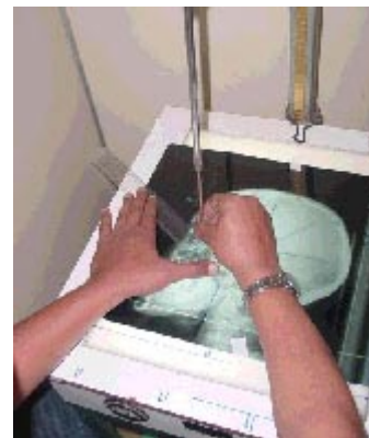
Figura 29 – Técnico cortando isopor conforme desenho no filme
