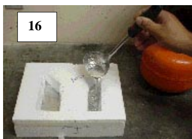
Figuras 14, 15 e 16 – Processo de derretimento do "alloy" e confecção do bloco de proteção
